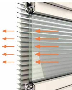
Zonwering aan de binnenkant laat de meeste warmte binnen.
